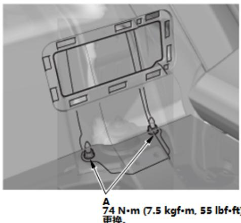
4. 松弛地安装新的减振器下安装螺栓 (A)。
