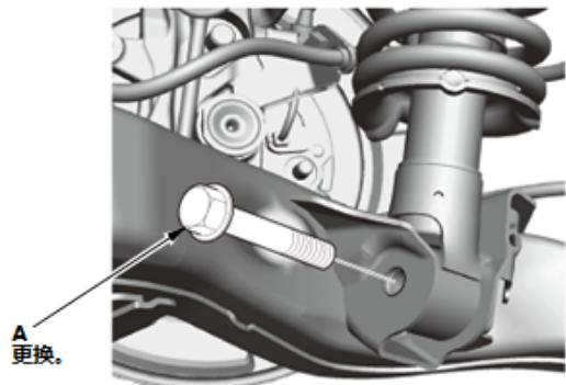
3. 拆下减振器/弹簧 (A)。
